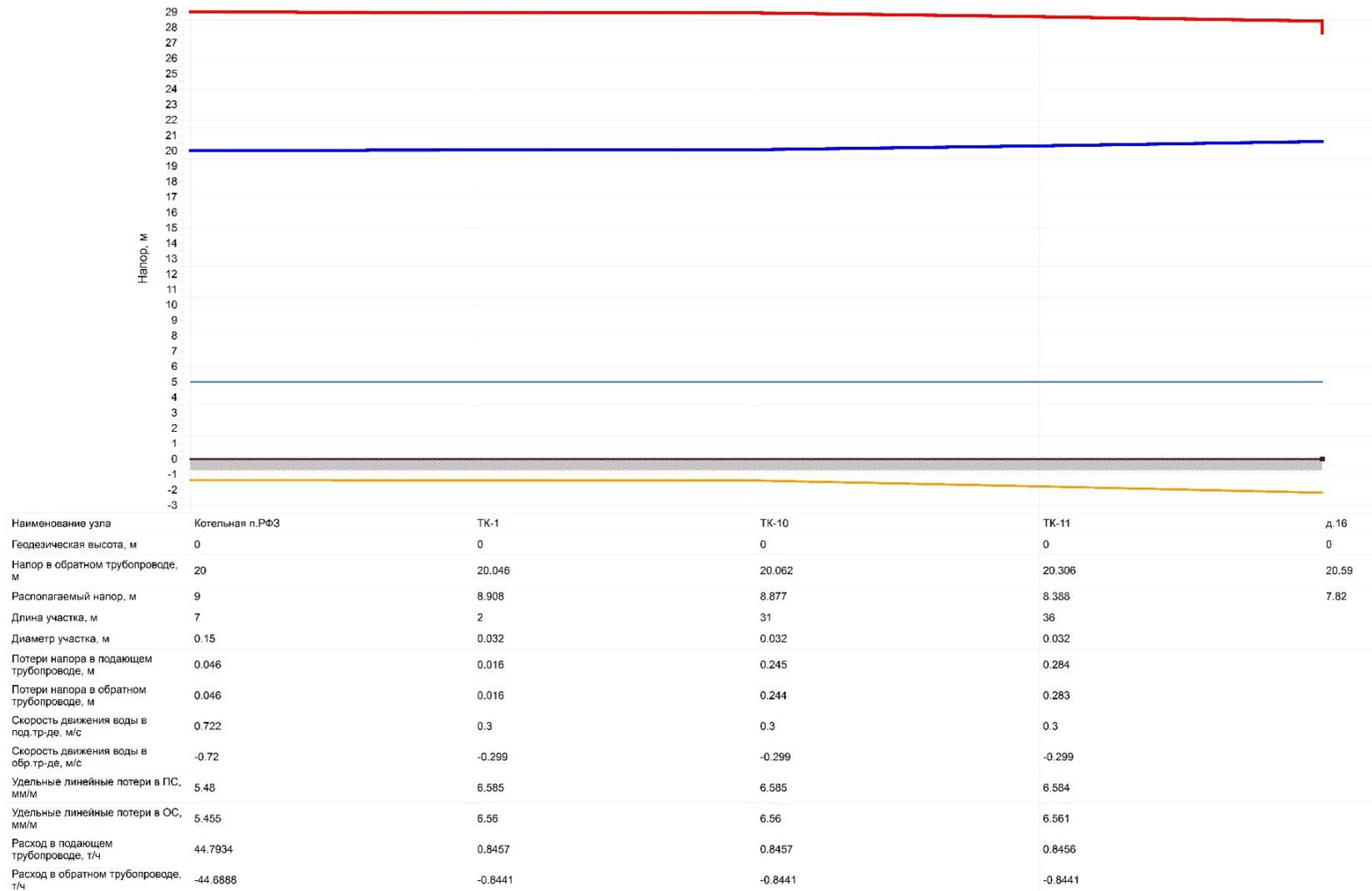
*Рисунок 6.2.2. Перспективный пьезометрический график от котельной РФЗ до потребителя д.16*
