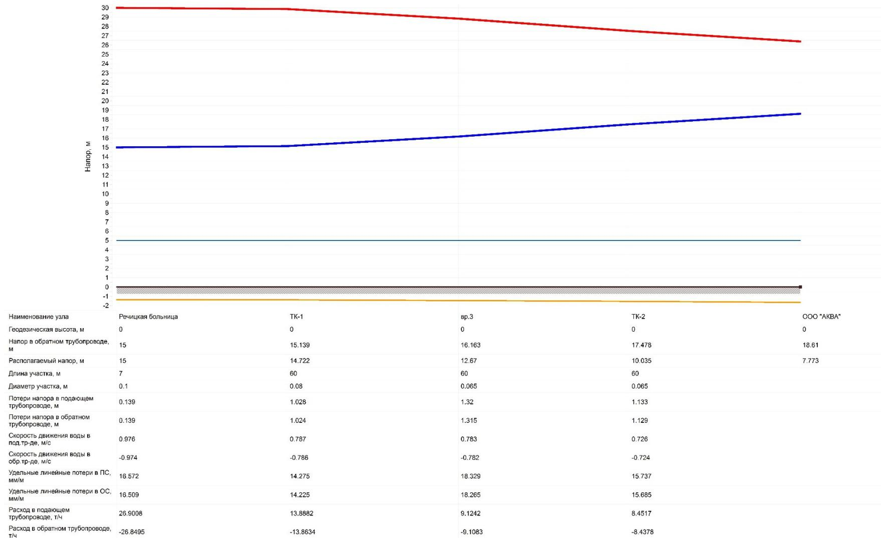
**Рисунок 6.1.1 – Перспективный пьезометрический график от котельной «Речицкая больница» до потребителя ООО Аква**
