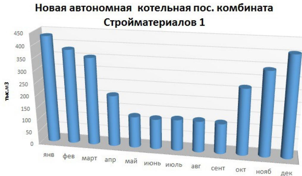
Рисунок 7.7.1 – Перспективный расчетный расход топлива по месяцам новой автономной котельной пос. комбината Стройматериалов 1.
