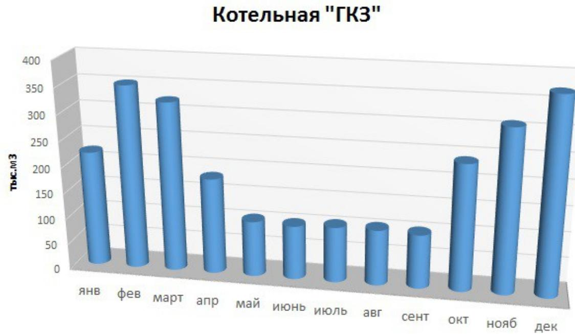
Рисунок 7.5.1 – Перспективный расчетный расход топлива по месяцам котельной «ГКЗ».
