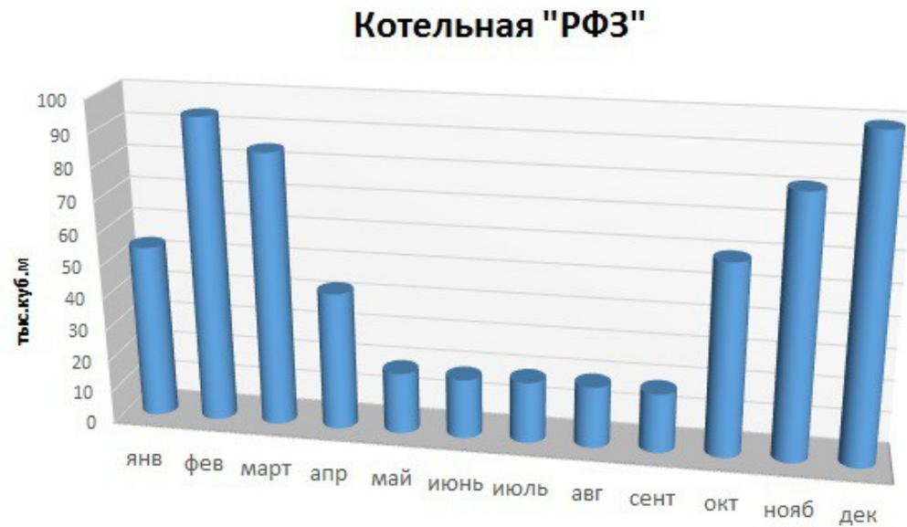
Рисунок 7.3.1 – Перспективный расчетный расход топлива по месяцам котельной «РФЗ»
