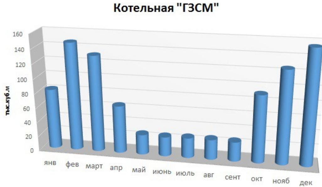
Рисунок 7.6.1 – Перспективный расчетный расход топлива по месяцам котельной «ГЗСМ».
