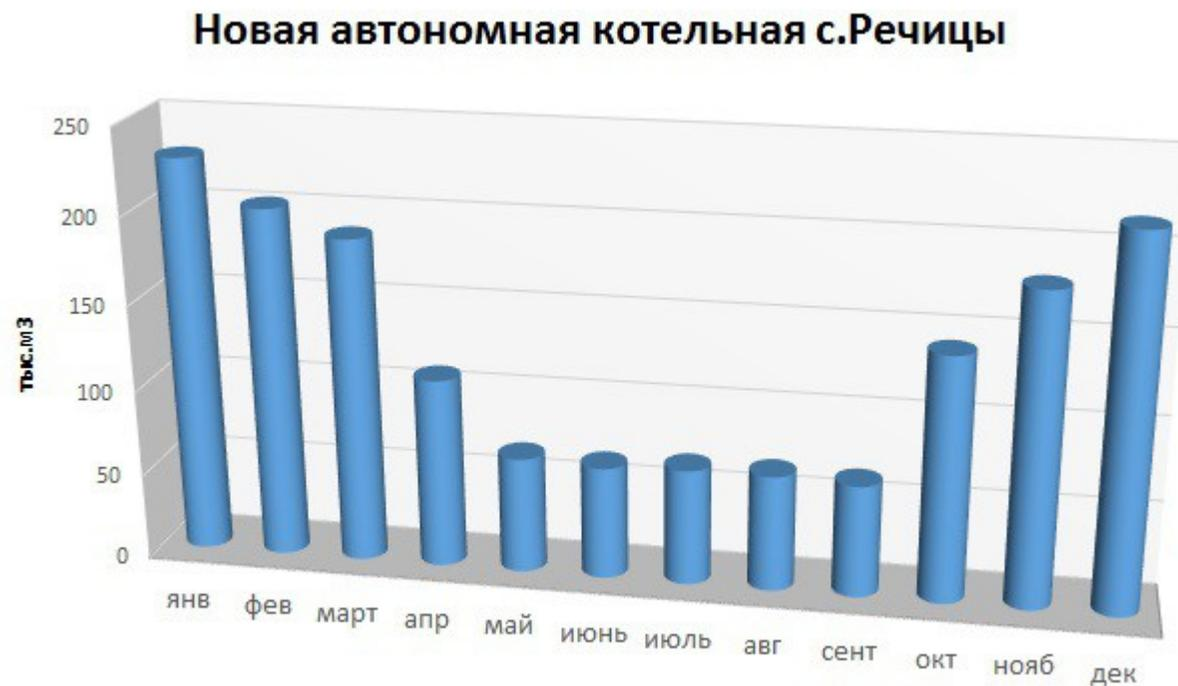
Рисунок 7.8.1 – Перспективный расчетный расход топлива по месяцам новой автономной котельной с.Речицы.
